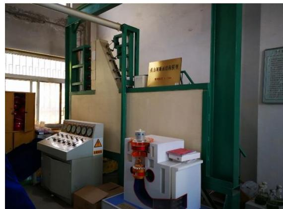
重力坝断面结构模型实验台
