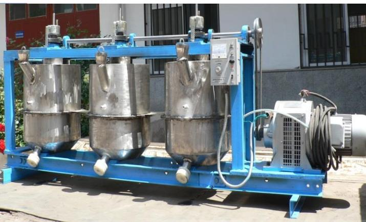
太阳能辅助加热恒温发酵装置
