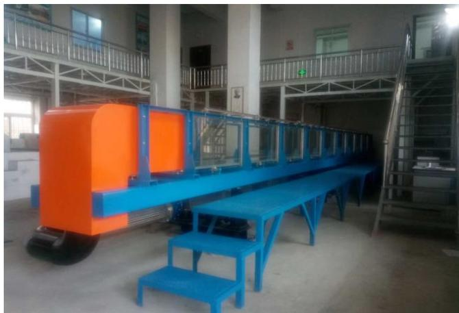
高精度变坡试验水槽台
