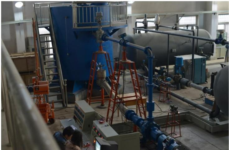
固液两相流泵实验系统
