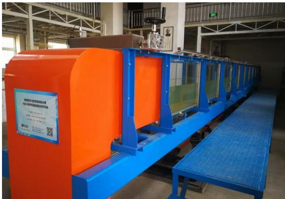
高精度多功能变坡水槽
