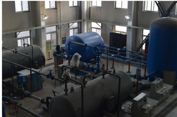
气液两相流泵实验系统
