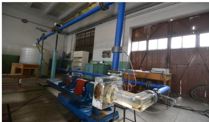
螺旋离心泵内流场可视化实验台
